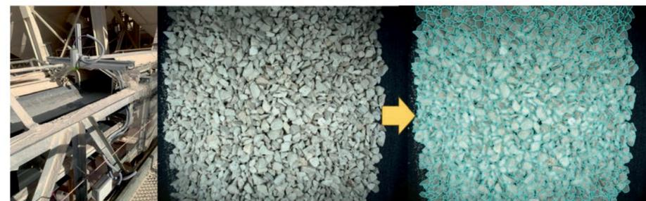
Figura 2. Determinación del tamaño de grano de manera continua mediante cámaras: ejemplo de segmentación y clasificación del proceso.
